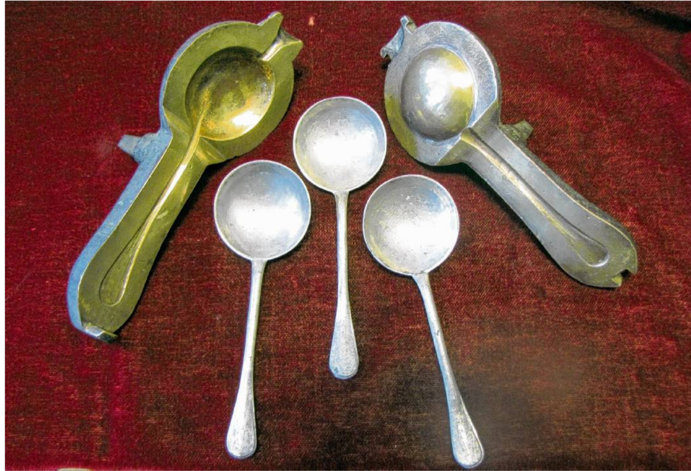
Zinnlöffel werden in Messingformen gegossen.
